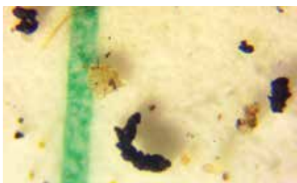
Analyse sur support membranaire de l'huile hydraulique standard AW 46 Grossissement = 100X
