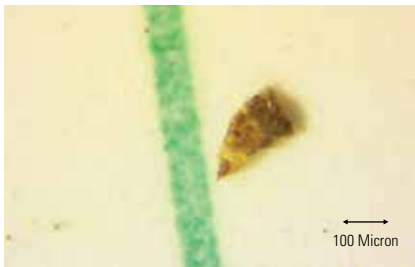
Niveau de contamination initiale de l'huile de transmission Code de propreté ISO 20/17/12.
